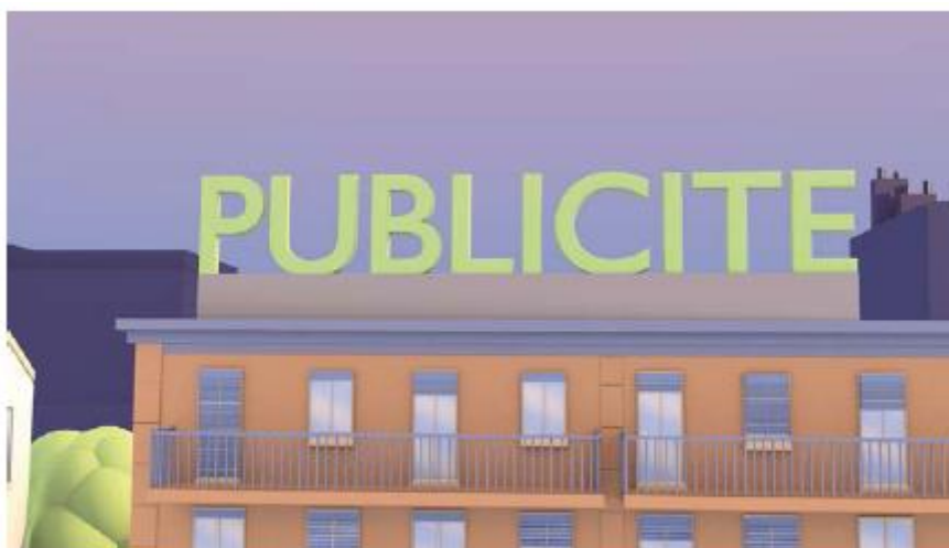
Une publicité lumineuse en toiture doit être composée de lettres découpées sans fixations visibles. Bandeau technique de 0,50 m maximum.
