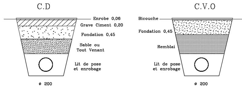
La pente minimum de pose est de 0.01 à 0,005 m/m. Sa profondeur varie en fonction du relief ; elle est en moyenne de 1,50/1,80 m.
